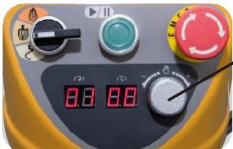
Stellen Sie den Geschwindigkeitsregler auf die gewünschte Geschwindigkeit ein, indem Sie die Geschwindigkeitstaste im Uhrzeigersinn drehen, um die Geschwindigkeit zu erhöhen, und gegen den Uhrzeigersinn auf eine niedrigere Geschwindigkeit.
