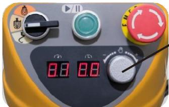
Stel de snelheidsregeling in op de gewenste snelheid door de snelheidsknop met de klok mee te draaien om de snelheid te verhogen, tegen de klok in om de snelheid te verlagen.
