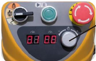
Réglez le contrôle de vitesse sur la vitesse souhaitée en tournant le bouton de vitesse dans le sens des aiguilles d'une montre pour augmenter la vitesse, dans le sens inverse des aiguilles d'une montre pour réduire la vitesse.
