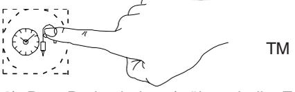
3) Den Drehschalter (während die Zahlen blinken) im oder gegen Uhrzeigersinn zur Eingabe der aktuellen Stunde drehen.
