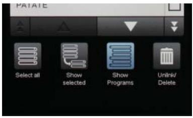
Die Presets können von den Programmen entfernt werden. Die Presets wählen, dann das Papierkorb-Symbol drücken (unlink/löschen) und die Taste ENTFERNEN drücken, um sie von den Programmen zu trennen oder die Taste LÖSCHEN, um sie vollständig zu entfernen.
