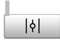
**Heißluftzyklus mit geöffneter Garraumlüftungsklappe:** Zum Trockengaren, ermöglicht bei Bedarf die Abführung der Feuchtigkeit (max. Temperatur 300°C).
