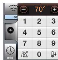
clavier pour régler la température de la sonde à piquer
