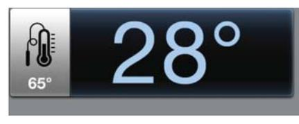
**Thermomètre / Thermostat numérique** pour le contrôle de la température au cœur du produit.
